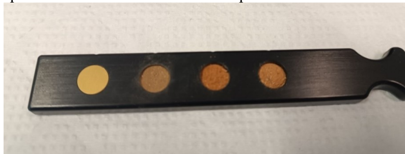
Figura 5 - Suporte do acessório DRIFTS com espelho de referência e amostras de solo
