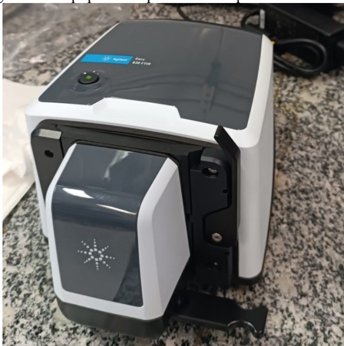
Figura 49 - Equipamento para leitura espectral na faixa MIR
