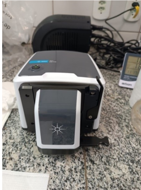
Figura 4 – Equipamento FTIR Cary 630 para aquisição de dados espectrais MIR
