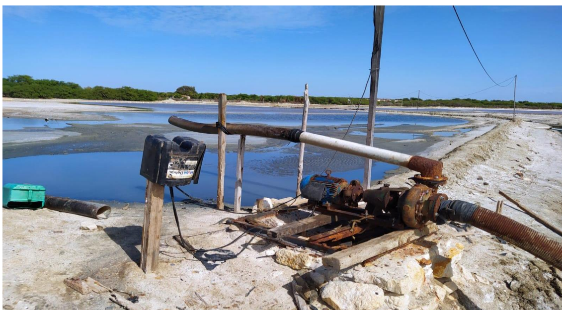
Figura 34. Bomba acoplada com motor elétrico usado para bombear a água.
