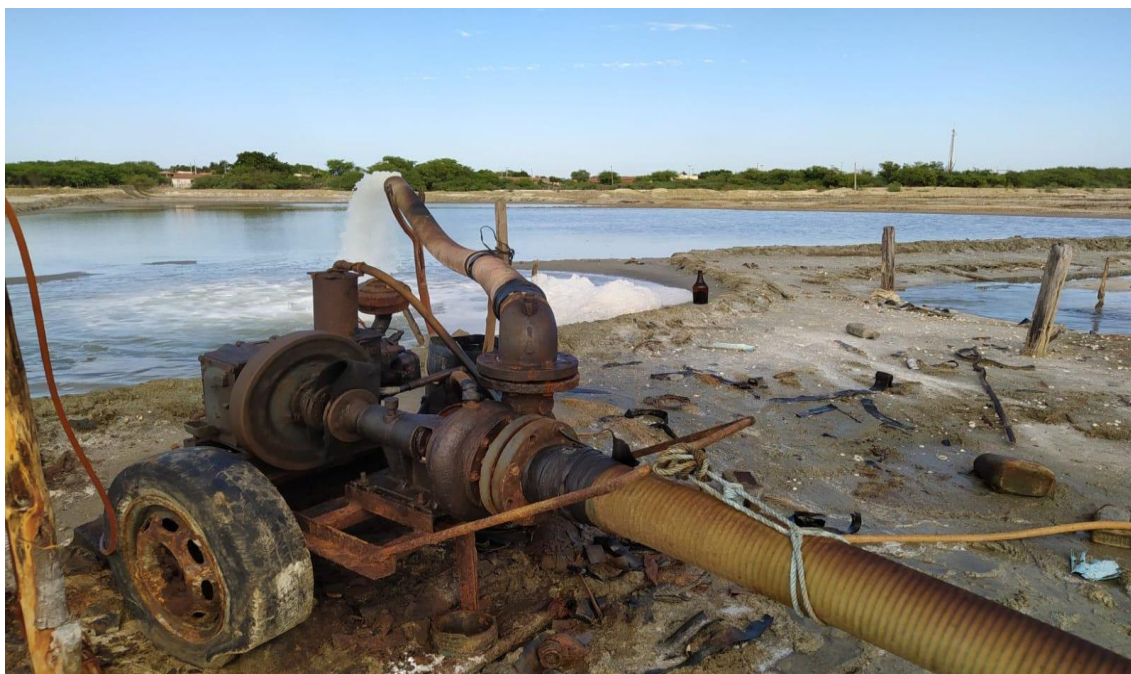
Figura 33. Bomba acoplada com motor a Diesel usado para bombear a água.
