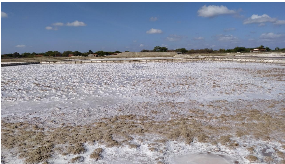
Figura 38. Mistura de sais de sulfato de cálcio (carago) e cloreto de sódio nos concentradores das salinas artesanais.
