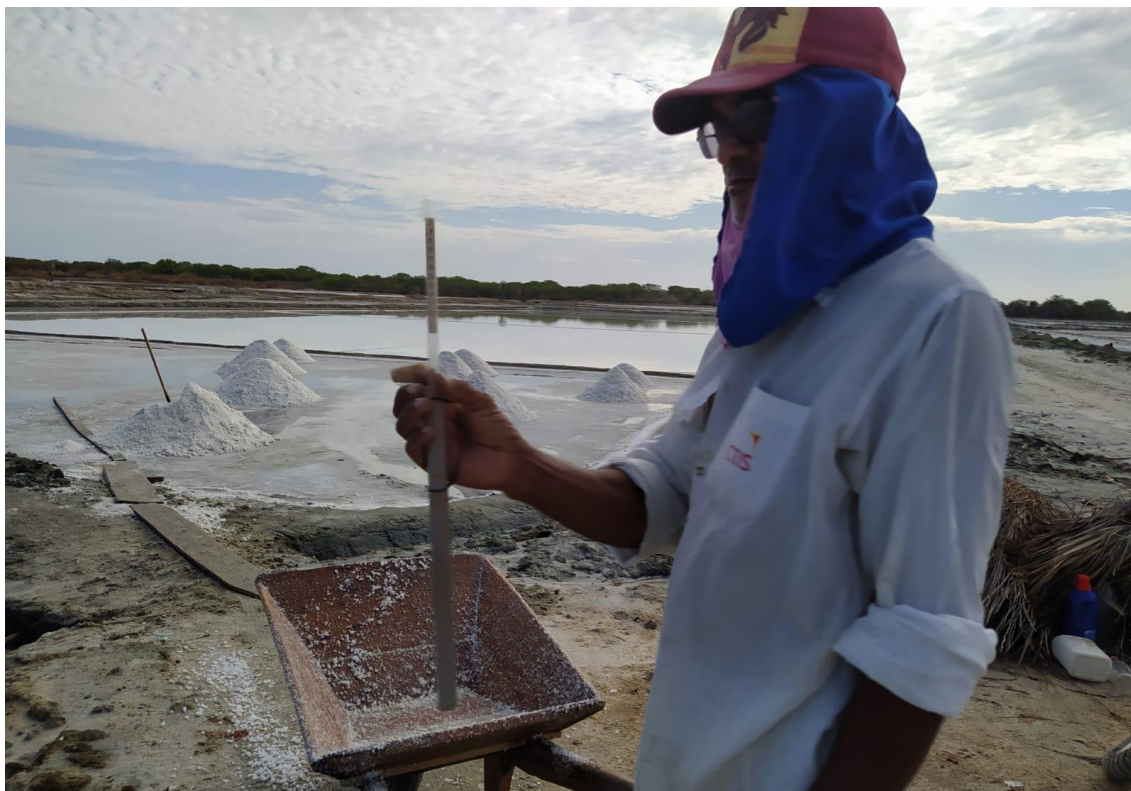
Figura 36. Salineiro medindo a densidade da água com o auxílio de um Aerômetro de Baumé.
