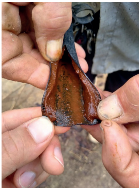
Figura 1. Acúmulo de precipitados de ferro e mucilagem produzida por ferro-bactérias. Fonte: os autores
