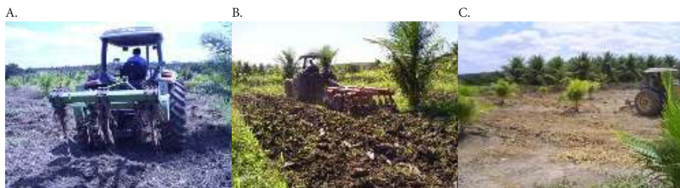
Figura 7. Realização da subsolagem (A), gradagem (B) e sistematização do terreno (C) no Setor A do Perímetro Irrigado Curu Pentecoste
