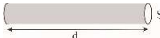
Figura 5. Condutor de comprimento d e seção S
